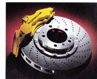
Néanmoins, l'usure des disques et surtout des plaquettes augmente considérablement en utilisation sur circuit ou en conduite forcée. Après un week-end sur circuit, les disques de freins PCCB, tout comme les disques conventionnels en acier, doivent subir un contrôle approfondi avec remplacement des composants, si besoin.
