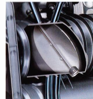
Clapet de réglage dans le système d'admission
